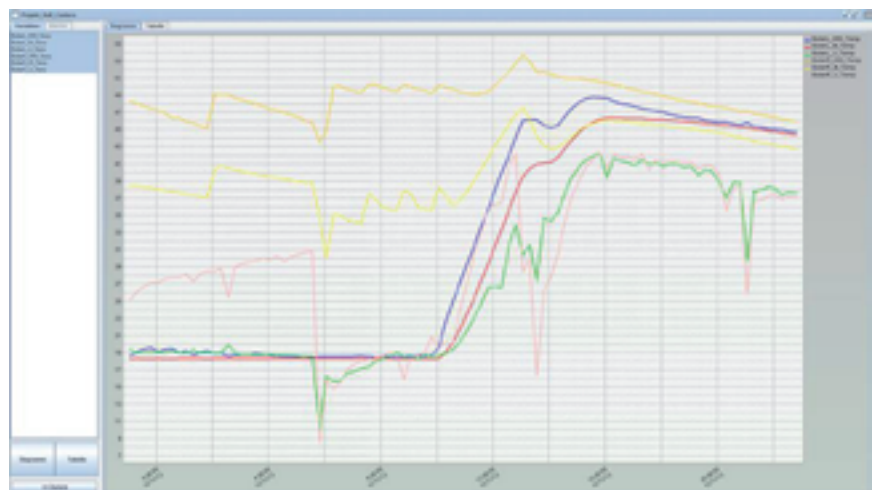
Die Temperaturen in den beiden Speichern an einem Tag. Die Zacken nach unten zeigen Entnahmen wie Duschen. Nachts wird einer der Speicher auch elektrisch nachgeheizt
